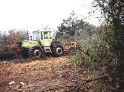
Abb. 24: Forstmulcher im Einsatz
